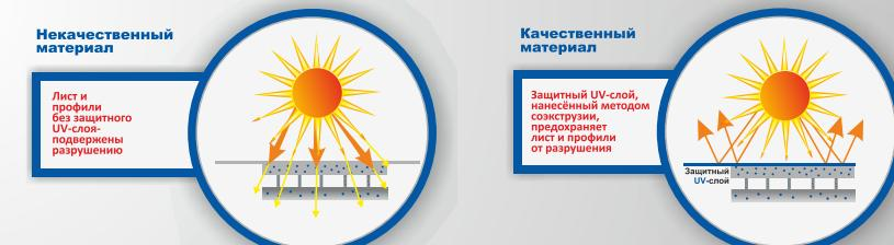
Схема воздействия солнечных лучей на лист сотового поликарбоната
